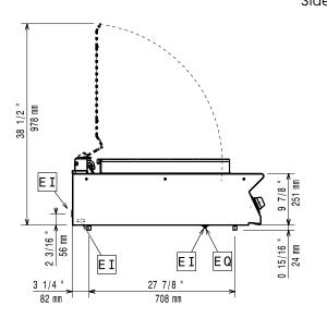
Drain ΕI Electrical inlet (power) EQ Equipotential screw Water inlet
